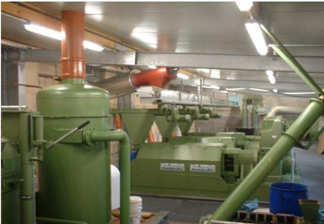
Vereinfacht dargestellt, wird das rohe Rapsöl mit Methanol und Kalilauge als Katalysator vermischt. Der rohe Biodiesel wird danach in einem Phasentrenngefäß von dem Nebenprodukt Glycerin getrennt. In den weiteren Verfahrensschritten wird der rohe Biodiesel weiter gewaschen, getrocknet und verfeinert, damit der umweltfreundliche Kraftstoff die erforderliche Qualität gemäß E DIN 51606 bzw. EN 14214 erhält und in Pkws und Lkws genutzt werden kann.
